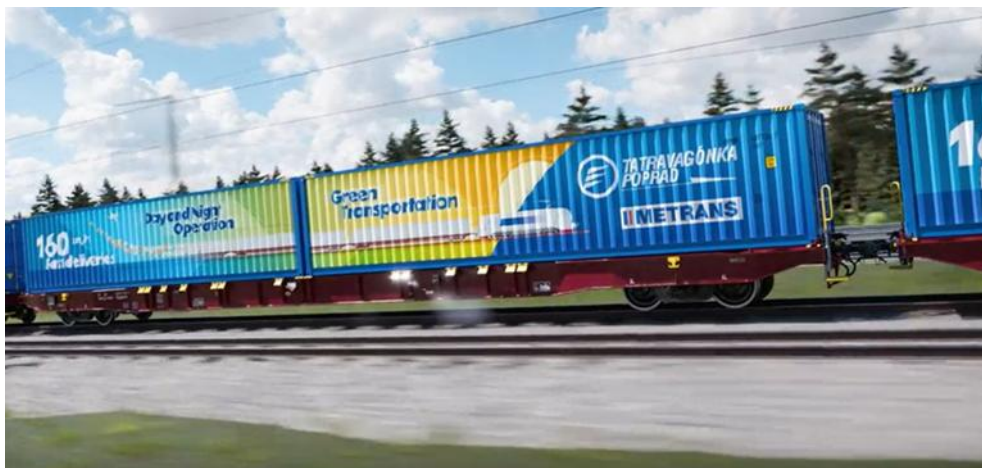
Figur 8.1: En boggievagn för två 40-fots-containers Sgmnss(S) med en största tillåten hastighet på 160 km/h från Tatravagonka visades på Innotrans i Berlin 2024.
